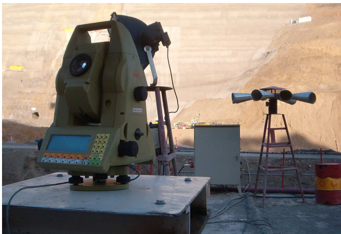
Los Cyclops vigilan 24h/24 y activan sirenas en el caso de movimientos sospechosos
