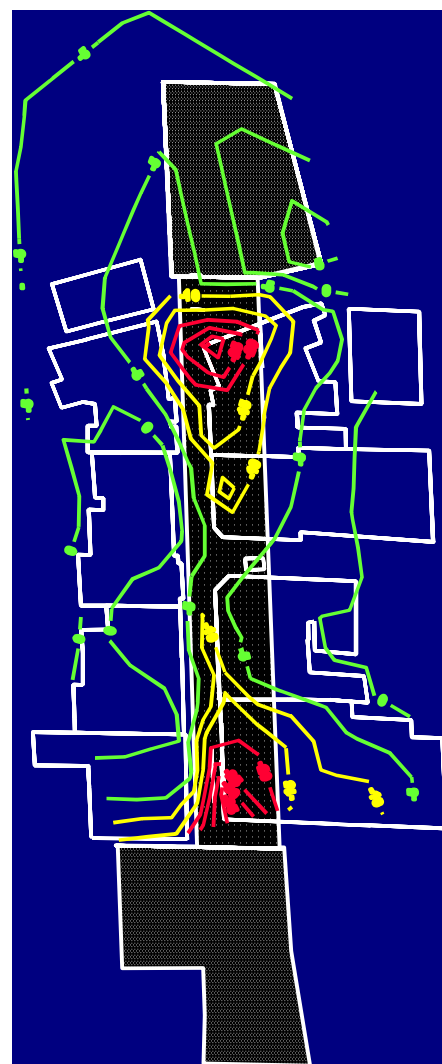
Visualisation du tassement en temps réel par CYCLOPS
