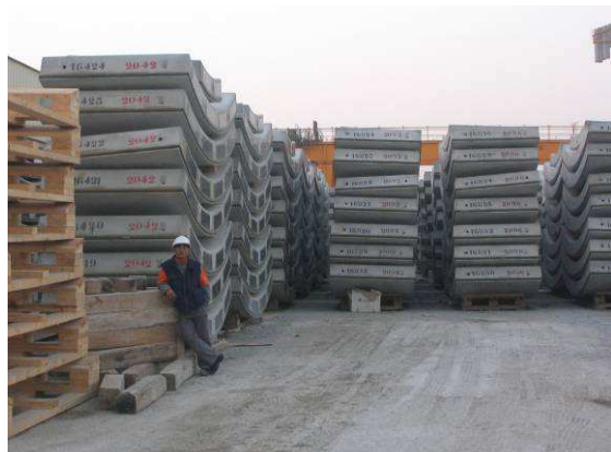
Aire de stockage des voussoirs
